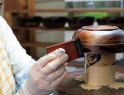
丁寧に漆を塗り一日寝かせて、さらに塗り重ねていくため、仕上げまでは何日も要する。座り込んで作業を続ける。
